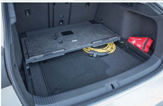
Befelé 1055 mm mély, a kerékdobok között 1000 mm széles a csomagtartó. Az elakadásjelzőnek külön helye van, így, amikor szükség van rá, nem legalulról kell elővárásolni
