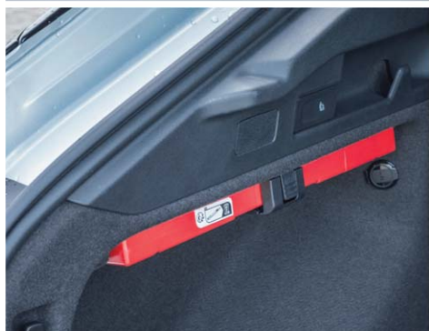
Befelé 1055 mm mély, a kerékdobok között 1000 mm széles a csomagtartó. Az elakadásjelzőnek külön helye van, így, amikor szükség van rá, nem legalulról kell elővárásolni
