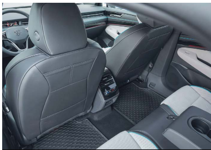
Hatalmas a lábtér, középen sík a villanyautós MEB padló. Az üléstámlára kis telefóntartó zsebeket is varrtak (felül), a légkondi harmadik (hátsó) zónája előfűtéssel aktiválható
