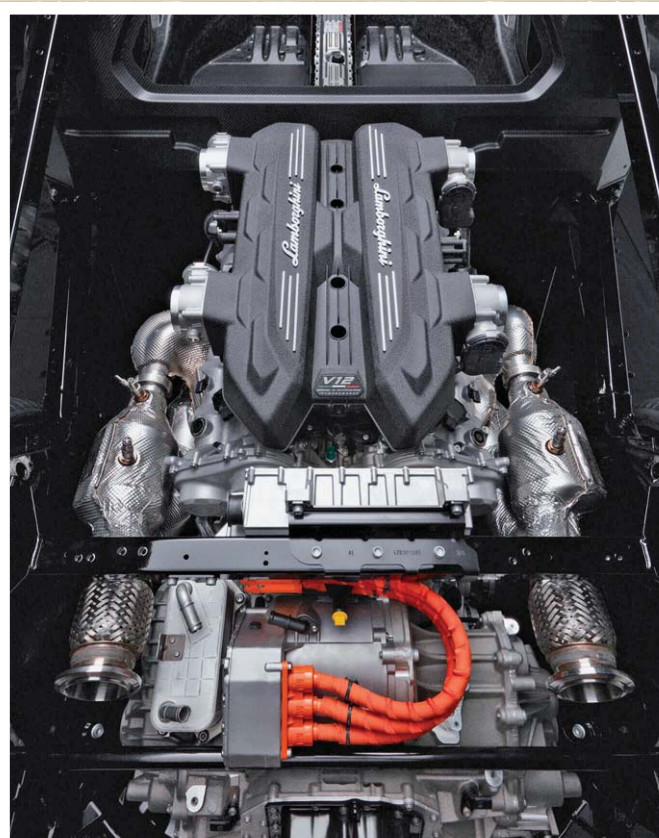
Az új, nyolcfokozatú duplakuplungos váltó – az Aventador hétsebességes egykuplungosával ellentétben – itt a motor mögött forog. Hátramente nincs, a Revuelto az első villanymotorokkal tolat
