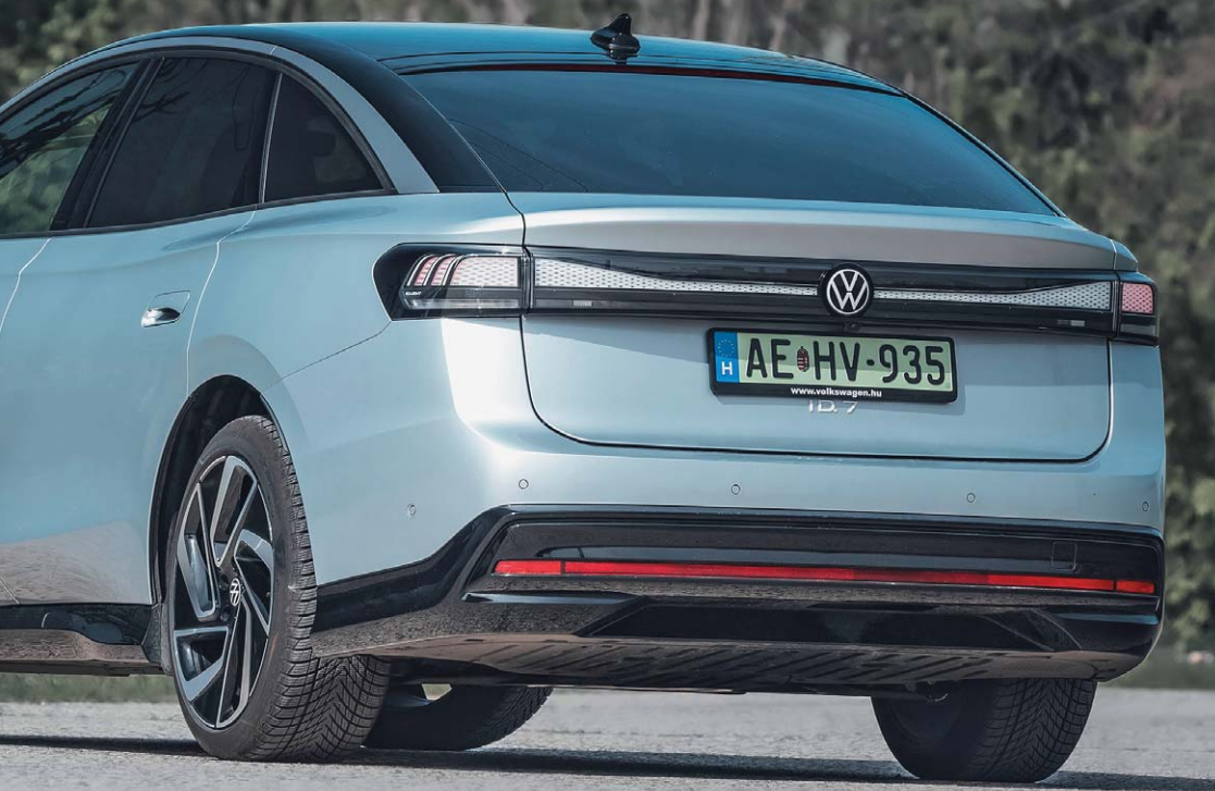
Szerény a vontatóképessége: fékezett utánfutóval 1000, fékezetlenül 750 kiló. A B-oszloptól sötétítettek az üvegek
