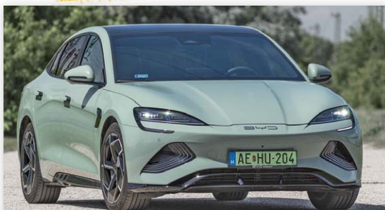
Teszten a BYD Seal, 82,5 kWh-s akkuval, két villanymotors összerakék-hajtással és 530 LE-vel.
