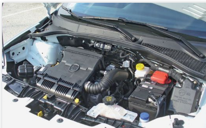
Csendesen teszi a dolgát a hosszúlökötűsége ellenére életvidám, szívócső befecskendezéses szívó 1,4-es. Startstopja gyors, és a hideg motorral kíméletes; nem állítja le amíg a hűtőfolyadék nem éri el legalább a 60-70 fokot
