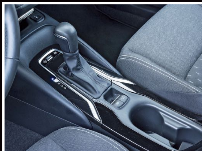
Elektromos a rögzítőfék és van elgurulás elleni Auto Hold is. A D alatt az erősebb motorféket adó B menetmód állása látható
