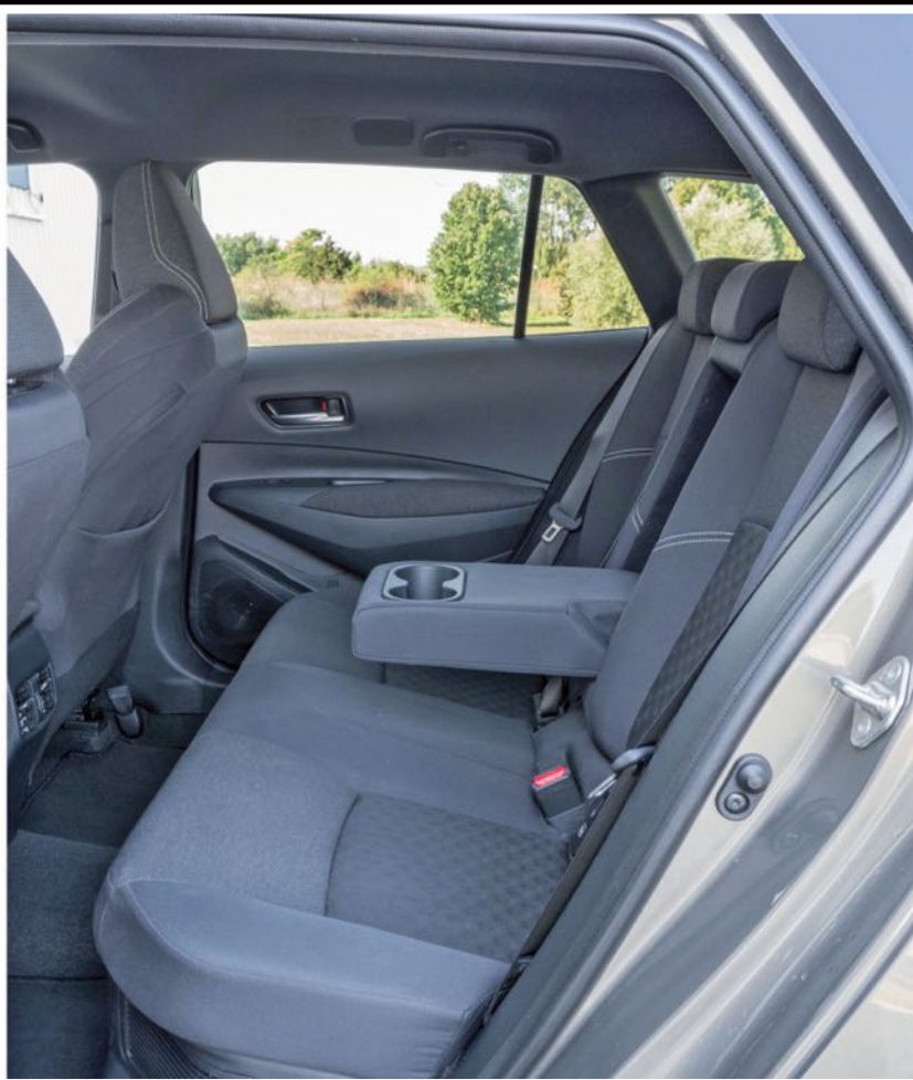
Más az ülések huzata, mint a Corollában. Hátul 5 mm-rel hosszabb az ülőlap, mint elöl, alatta a hibrid rendszer akkumulátora utazik (ezért van a szellőzőrács is)
