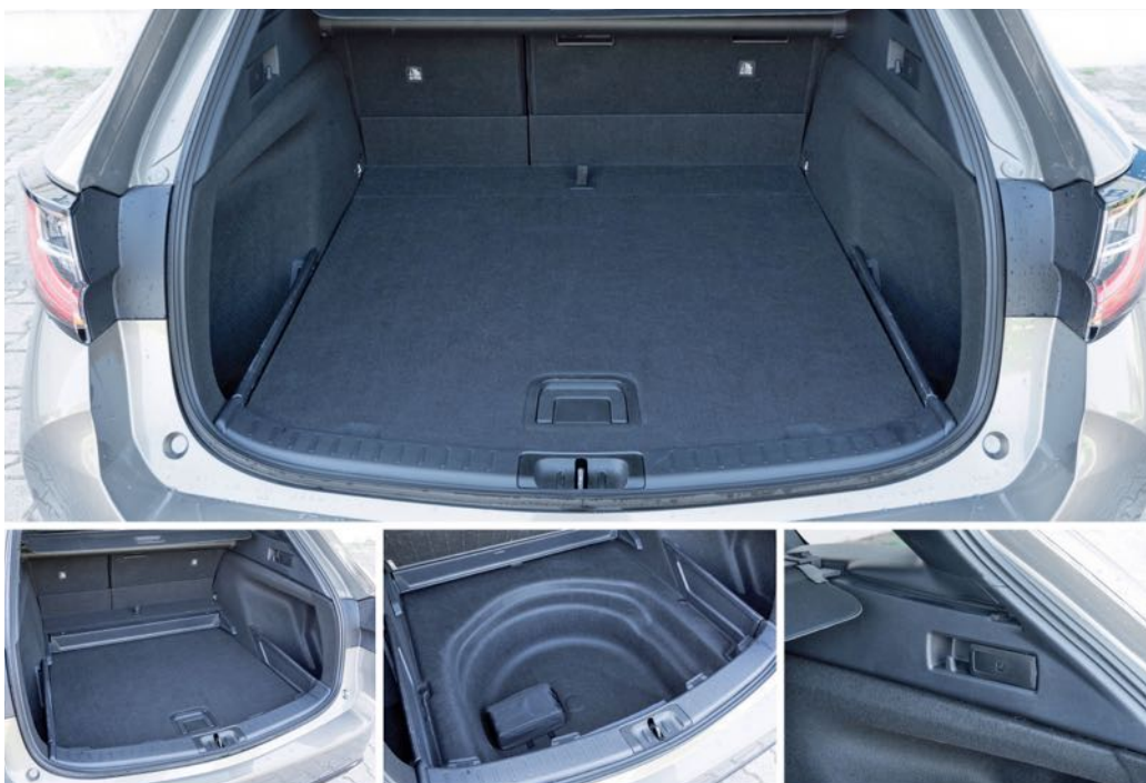
Két szinten rögzíthető az álpadló, alatta a mankókerék üres mélyedése további extra helyet ad. A hátsó üléstámlák innen is dönthetők egy-egy kar meghúzásával
