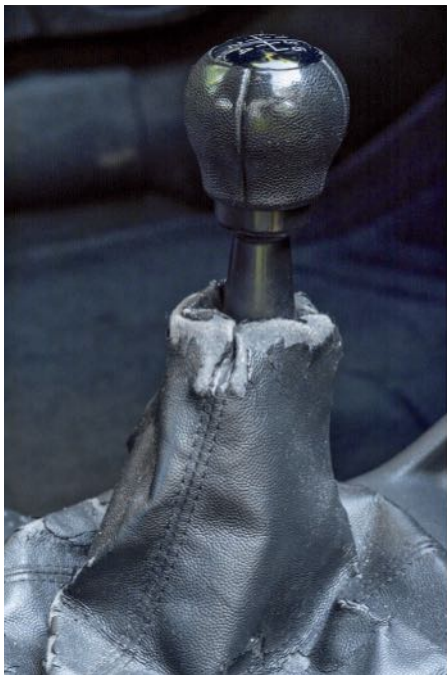
Csúnya: 20 év alatt megadta magát a műbőr a váltókarán és a kézi-fékkarnál is. A kormány a küllőknél is kopott. Utólag került bele rádió, a gyári 2 DIN-es helyére. A fűtés/szellőzés vakon kezelhető a három tekerővel, a piktogramok nem koptak le
