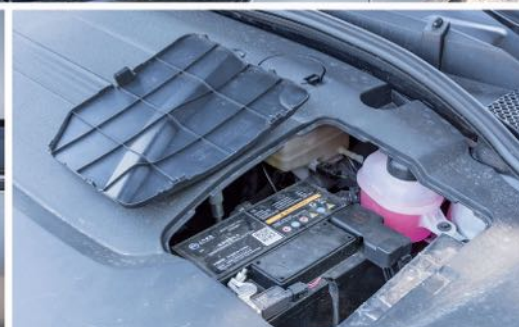
Teljesen burkolt a gépház, nyílást csak az ablakmosó tartályának vágta és könnyen hozzáférhető a 12 V-os akku is
