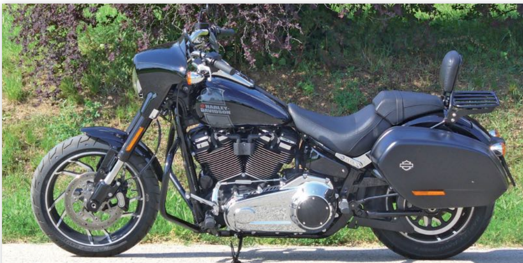
A váltókar finoman jár, de hosszú utakon, az ürest különösen hidegen nehéz megtalálni. A gyújtótrafó négy gyertyakábele a hengerenkénti két gyertya jele
