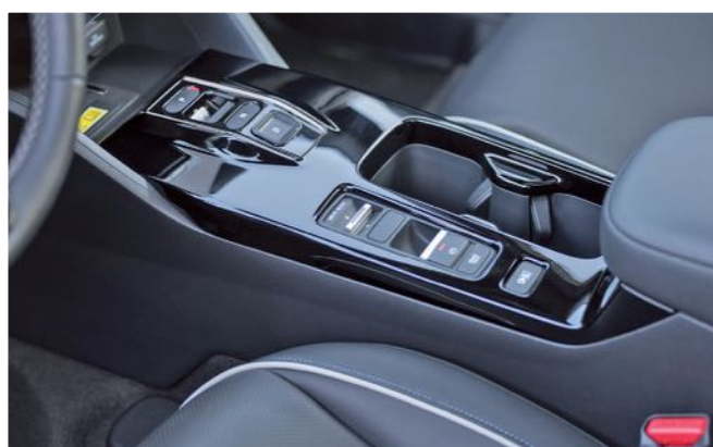
Új Hondákban mondhatni szabványos ez a középkonzol. A menet-iránynál a hátramenetkez nem nyomni, hanem húzni kell a gombot
