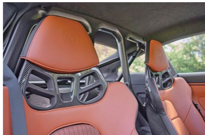
Minden könnyített: az üléseknél, a bukócsőnél is látható a karbon, a karosszériaelemek szintén ebből az anyagból készültek
