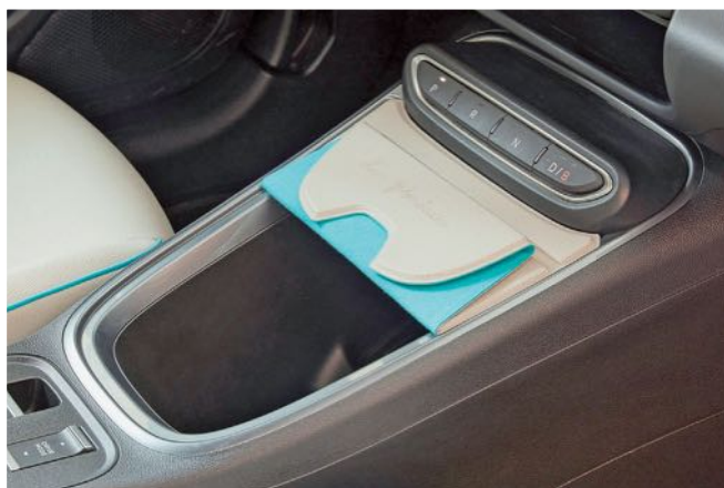
Gombnyomással választható menetirány, a D mellett van nagyobb motorfékelt adó B üzemmód is. A hajtogatható párna takar(hat)ja a kíváncsi szemek előtt a tárolóban lévő tárgyakat
