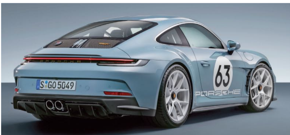
Szándékosan nincsenek rajta légterelők, hogy minél jobban hasonlítson az 1969-es 911 ST-re. A hátsó tengely sem kormányzott
