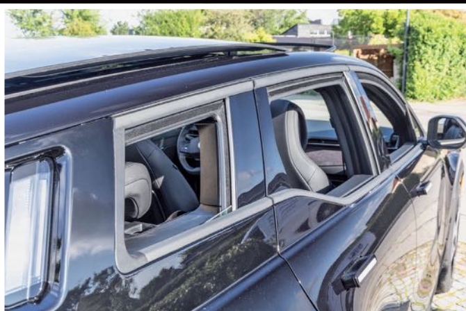
A Fisker "California Mode"-nak hívja: az autó összes üvege – az első szélvédőt kivéve – nyitható
