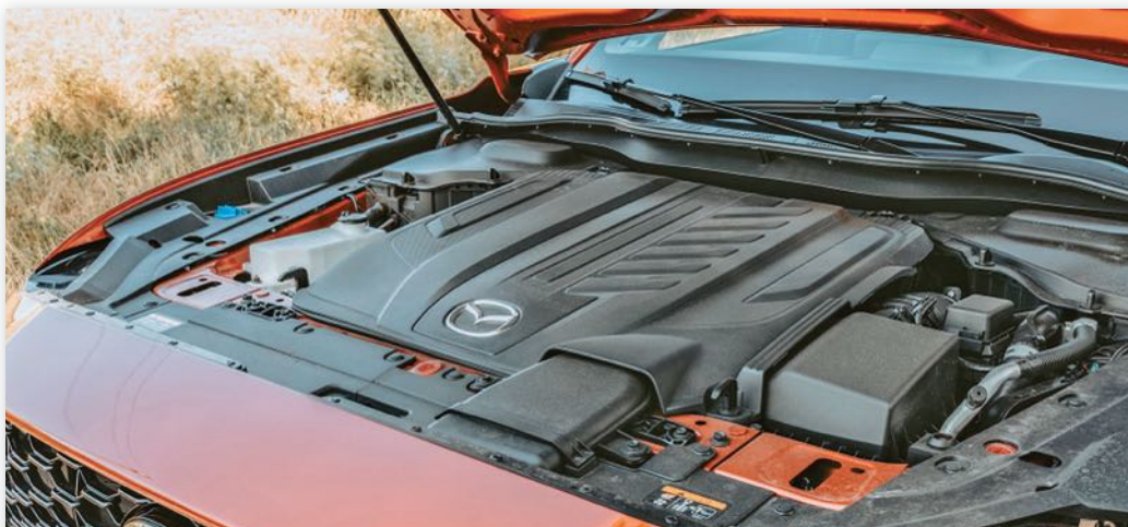
Hatalmas burkolat alatt forog a hosszában beépített dízel. A 3,3 l-es gép messze nincs „kihegyezve” a 254 LE-s teljesítménnyel, bőven lehet még benne tartalék
