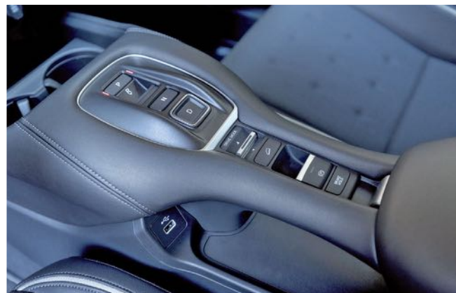
Nyomógombos a menetirányváltó, a hátramenet húzómozdulattal kapcsolható. A menetvezérlő (Drive Mode) Eco, Normal, Sport és téli, csúszós útra való Snow programokat tud
