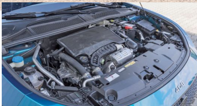
Annyi Stellantis típusban megtalálható ez a turbós 1,2-es benzines, hogy nem is tesznek rá márkajelölést
