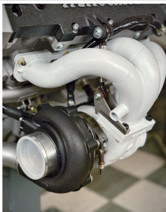
A turbók fix geometriájúak és egyformák
