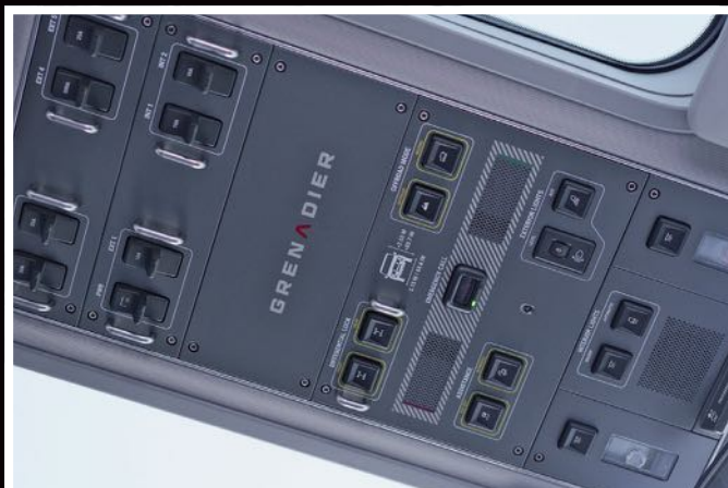
Látványos a műszerfalra rímelő, „military” stílusú tetőpanel. A tervezők igyekeztek a fontosabb kapcsolókat a lehető legmagasabbra emelni, hogy védjék őket a víztől
