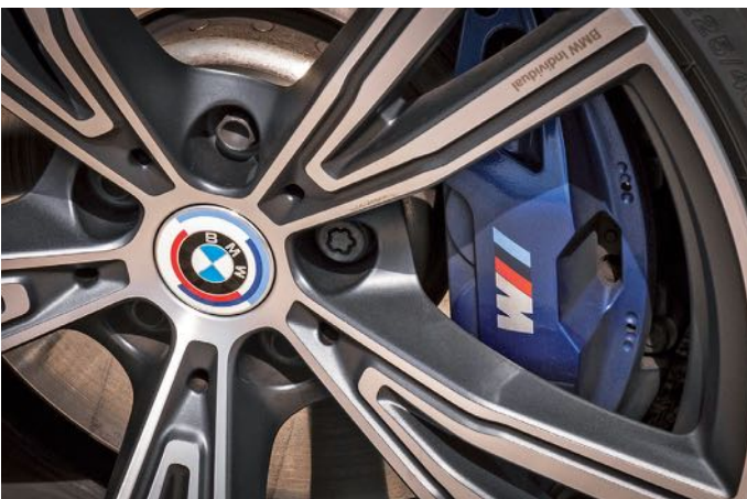
Kék vagy piros nyereggel választható az M Sport fékrendszer. A tárcsák elől-hátul hűtötték
