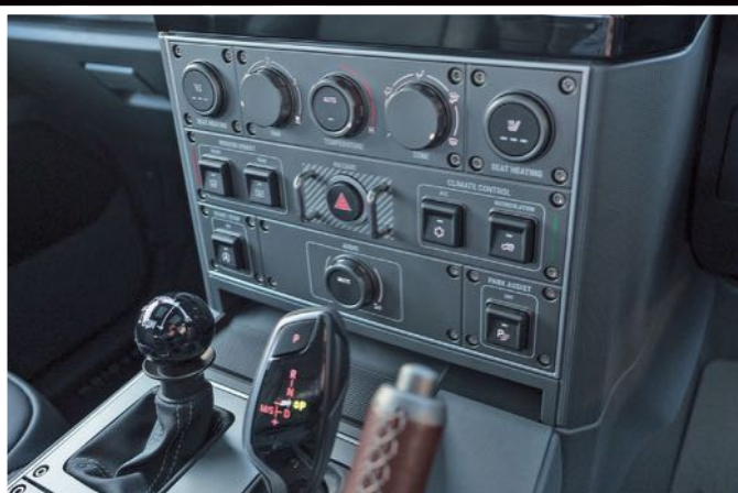
A központi difizár és a felező, a nyolcfokozatú automata BMW-kből is ismerős kapcsolókarja melletti, kemény járású fogantyúval kapcsolható
