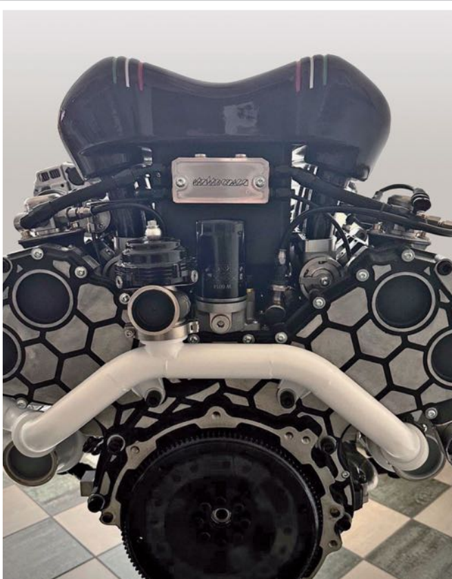
4000/perc alatt csak az egyik turbó tölt
