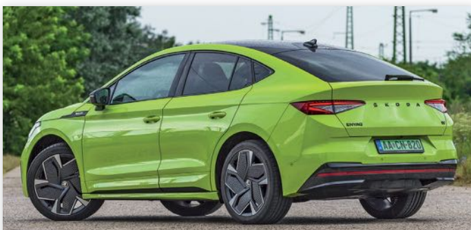
18 centi a hasmagasság, a vontatókapacitás fékezett utánfutóval 1200–1400, fékezés nélkül 750 kg
