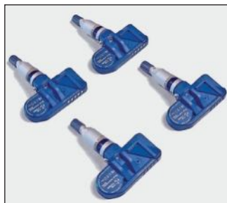
A keréknyomás-érzékelők elektronikájának háza vízálló
