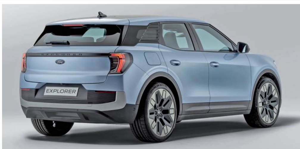
Jól látszik, hogy a csomagtérajtó nem nyúlik le mélyre, így a rakodóperem magas. Kár, hogy a töltőnyílás nem a frontrészre, hanem oldalra-hátra került
