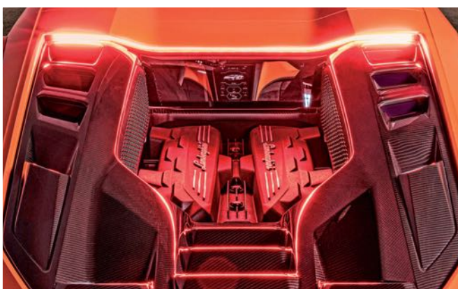
Hosszában forog a 6,5 l-es V12-es, de a váltó keresztben kapcsolódik hozzá. Villanymotorból összesen három van
