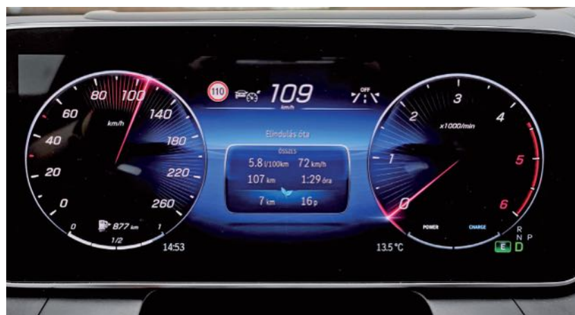
Tűéles a kép a 12,3 colos műszeregségen. A sebesség 109 km/h, de a fordulatszám-mérő mutatója a 0-án pihen – nem jár a motor!
