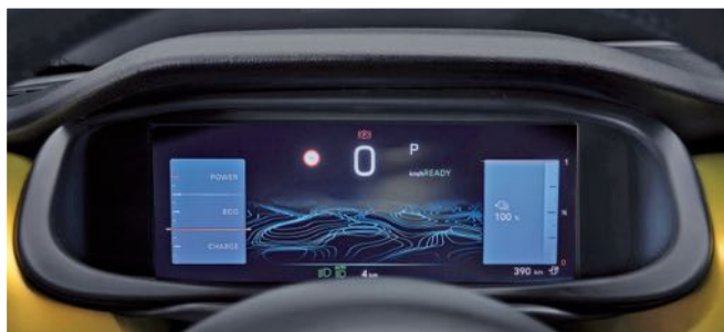
Ez a nagyobb, 10,25 colos műszeregység, de alából csak 7,0 colos jár – az analóg órák ideje képletesen szólva lejárt
