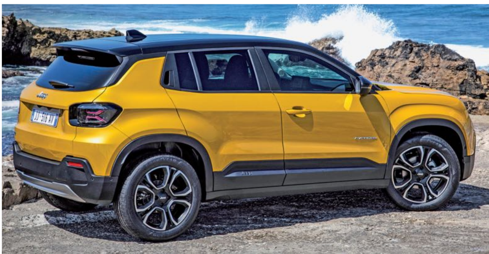
Jók a terepszögek (20/20/32 fok), a hasmagasság 200 mm. Acél keréktárcsa nincs, az aluk 16-18 colosak
