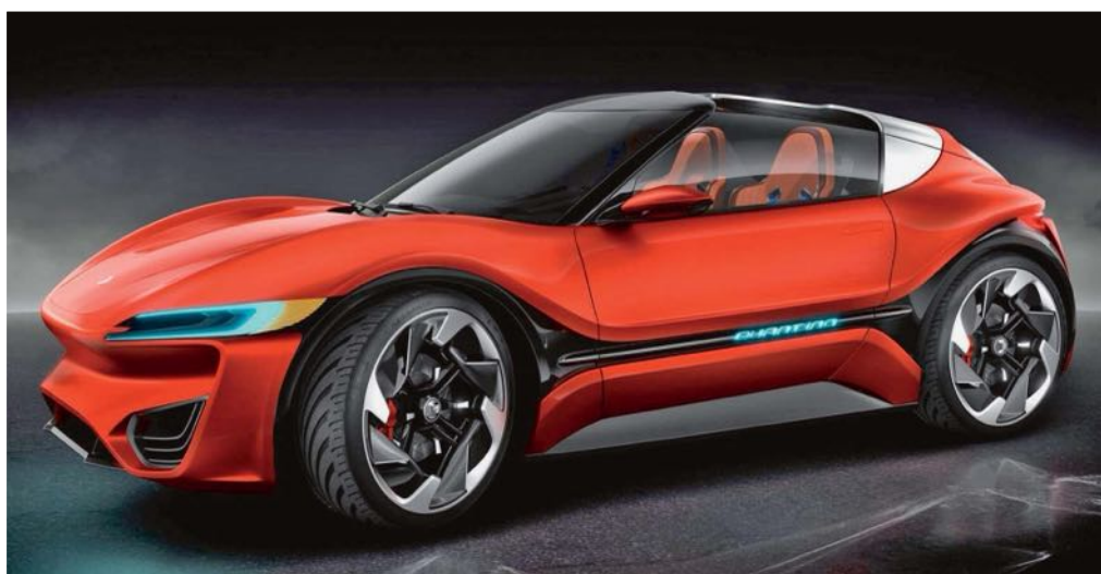
A 3,9 m hosszú és 320 LE-s kétülé- ses Quantino Twentyfive menetkészen nagyjából 1500 kilót nyom. A korábbi, hátsókerék-hajtású változattal ellentétben itt már kerekenként egy-egy villanymotor hajt
