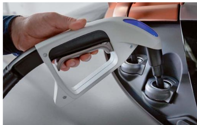
A tankolás egyszerű, a Nano Flowcell által szabadalmaztatott kútoszlopból egyszerre tölthető a pozitív és a negatív töltésű sóoldat. A folyadék akár évekig is megőrzi energiatartalmát
