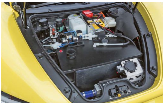
A hajtáslánc kondenzátorai a Quantino orrában. Az újabb változatok 48 V-os névleges feszültségével nagy áramerősségek járnak, de a fejlesztők szerint ez nem okoz napi használati gondot
