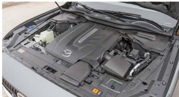
Hosszában forog a négyhengeres, amely a burkolat alatt szinte elvész, mert a helyet soros hathengeresekre méretezték – utóbbiból van benzines és dízel is
