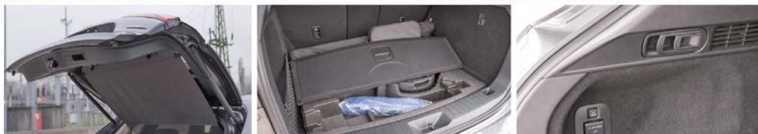
Befelé 910 mm mély és 1130 mm széles a csomagtartó. A kalaptartó az ajtóval együtt mozog, így nincs útban, a 12 V-os csatlakozón kívül ide is tettek 220-as dugaszt, amelynek teljesítménye 1500 W
