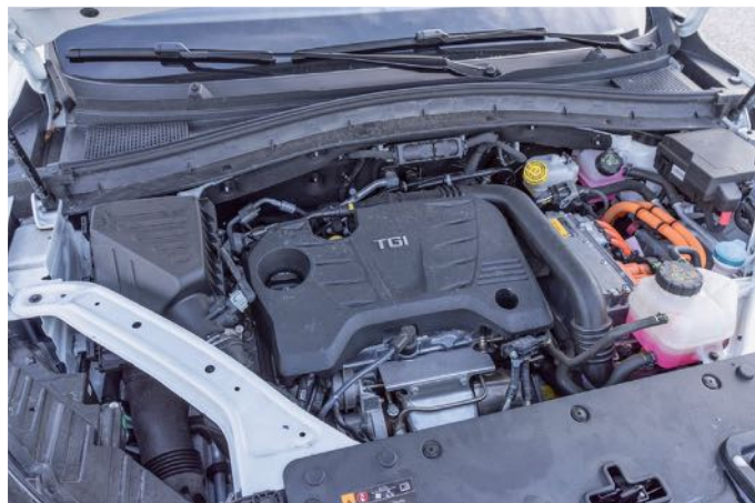
Keresztben építik be 1,5-ös turbós négyhengeres, összerékáthajtás az EHS-hez pluszpénzért sincs
