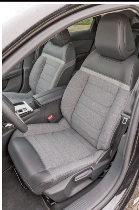
Kellemes a szövetkárpit, kényelmesek a puhára tömött ülések, a helykínálat elől-hátul nagyvonalú. A hátsó ülőlapok rövidebbek az elsőknél (505 helyett 490 mm-esek)
