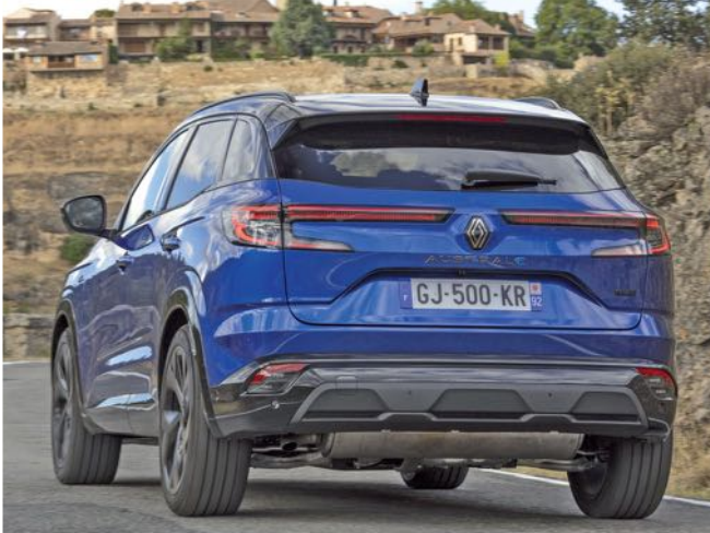
Az Austral összes fényforrása LED-es, összkerék-kormányzással a fordulókör átmérője 11,2-ről 10,1 m-re csökken. A könnyűhibridek-hez társított automataváltó hét fokozatban léptethető CVT
