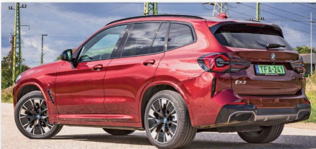
Igásló is lehet: a tetőre 100 kilónyi holmi pakolható, vontatni 750 kilót tud, vízben 7 km/h-s sebességgel haladva 500 mm a gázlómélysége
