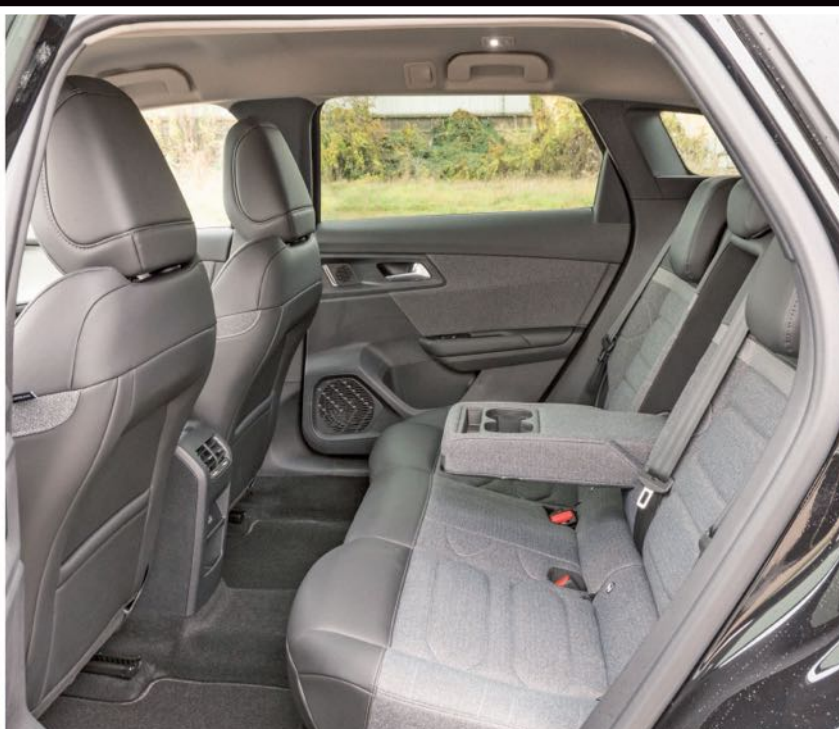
Kellemes a szövetkárpit, kényelmesek a puhára tömött ülések, a helykínálat elől-hátul nagyvonalú. A hátsó ülőlapok rövidebbek az elsőknél (505 helyett 490 mm-esek)
