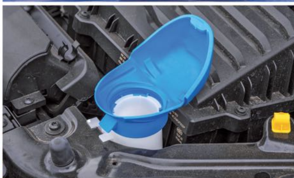
Látványos a hűtőmaszk bordázata. Jó helyre (középre) került a gépháztető biztonsági zárjának nyitófüle. Simply Clever, azaz skodás okosság: kinyitva tölcseért formáz az ablakmosó tartály kupakja
