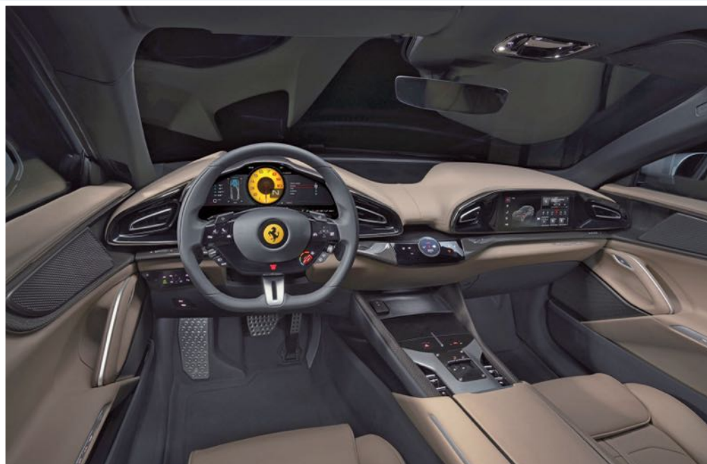
Vezetőközpontú a kialakítás, de az utasnak is jut képernyő. Az irányjelző, a világítás, az ablaktörlő a kormányról működtethető
