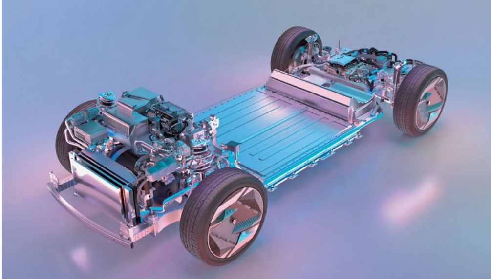
A CMF-EV padló hordozza a Mégane Electric-et is, az akku a padlóban, az üzemanyagcella és a hidrogéntartály az orrban, a villanymotor pedig hátul. A Scénic Vision hátsókerék-hajtású
