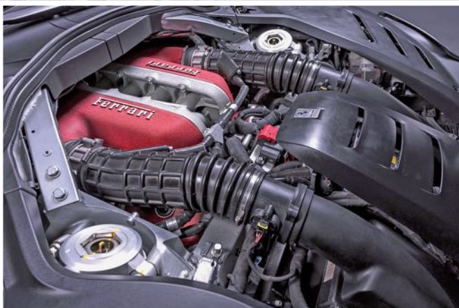
Amennyire csak lehetett, hátratólták a V12-est, hogy ne terheljék túl az első tengelyt. Jól látszanak a tornyoktól a tűzfal felé tartó merevítők
