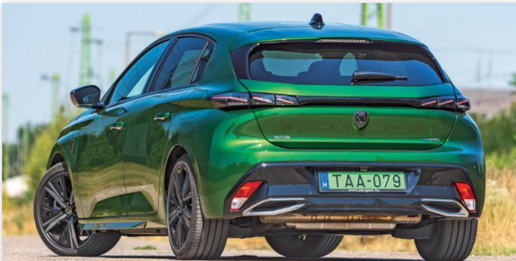
Berácsolták a krómozott kipufogóvégeket, egyik sem igazi. A rakodóperem 690 mm magas
