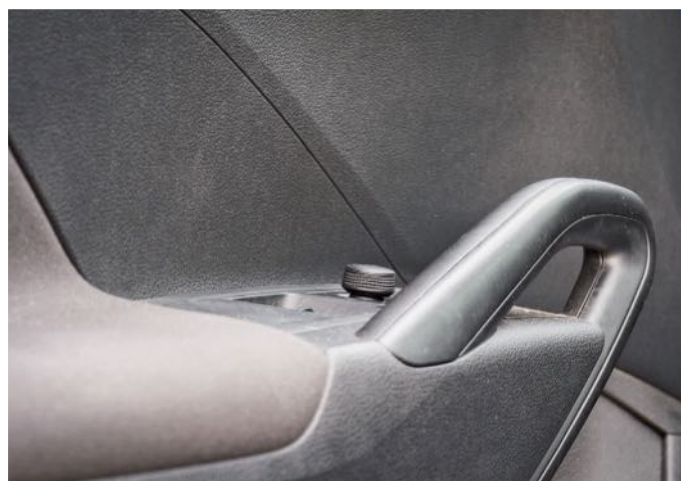
Kartámaszba süllyesztett mélyedés helyett jól kézre álló behúzó került az első ajtókra
