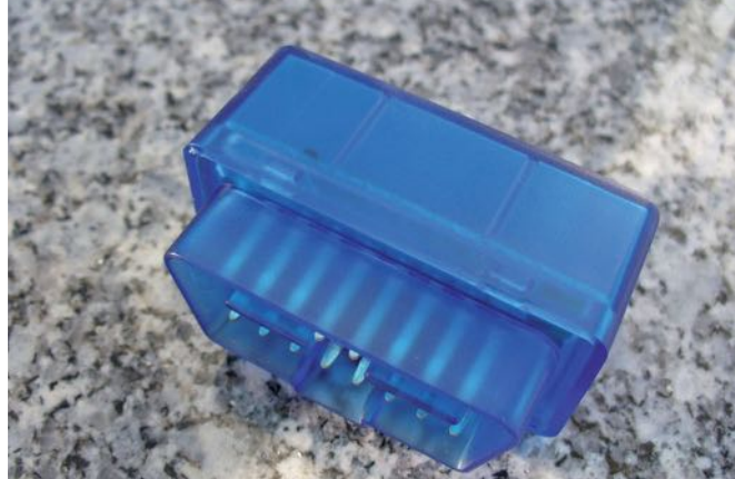
Az olvasó kicsi (4,5 x 3,0 x 2,0 cm) és könnyű, a telefonhoz és az autóhoz való kapcsolódást jelző LED-ek az áttetsző műanyag ház alól világítanak
