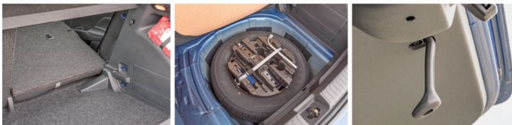
1000 mm széles, befelé 745 mm mély a csomagtartó. A padlóba tett pótkerék kb. 40 l-t rabol a 380 l-es alapteretből. A gumi lehúzóval könnyed mozdulat az ajtó lecsukása
