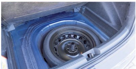
Befelé 815, a kerékdobok között 1005, legszélesebb pontján 1225 mm széles a Polóénál nagyobb csomagtartó. A 125/70-es mankókerék gumija kínai Linglong
