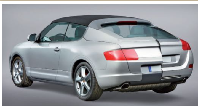
Porsche Cayenne Cabrio Concept – PFM, úgynevezett Package Function Model. A tető a későbbi 991-es sorozatú 911 Targához hasonló megoldással nyílt
