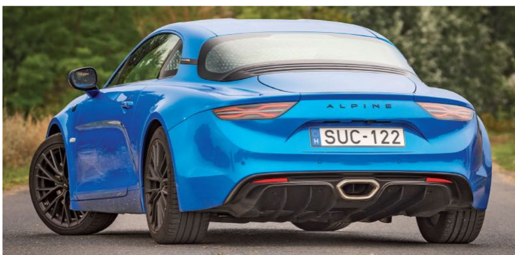
Elöl és hátul egyaránt kettős háromszög-lengőkaros a felfüggesztés, a csillapítás nem adaptív. A diffúzor igazi, a szinte folyamatosan durrogó kipufogó is ezért került középre
