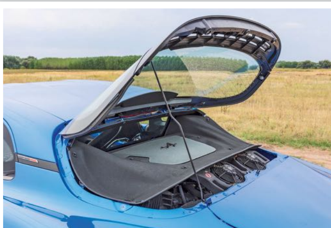
Macera: három rejtett csavar oldásával, a csomagtérből nyitható a hátsó szélvédő, a motort takaró burkolatot azonban további csavarok rögzítik, ezt már nem vettük le
