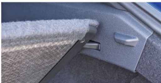
Befelé 815, a kerékdobok között 1005, legszélesebb pontján 1225 mm széles a Polóénál nagyobb csomagtartó. A 125/70-es mankókerék gumija kínai Linglong
