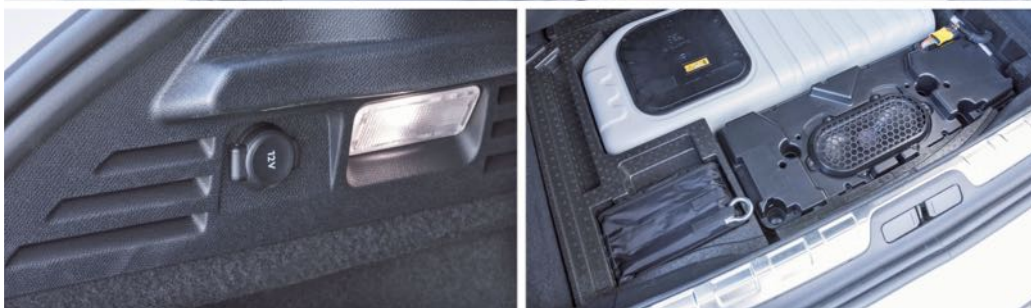
Némi rakodóhelyről le kell mondani a hibrid esetén, de a 390 l-es csomagtartó így sem a kategória legkisebbe. A mélység befelé 770, a szélesség 1090 mm. A padlóban jobbra a Focal hifi mélynyomója
