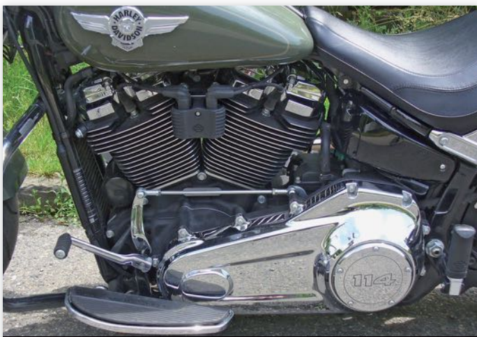
Az előre tolt váltókar finoman jár, hosszú utakon; az ürest hidegen időnként keresgéltni kell. A hengerek V-jében a gyújtótrafó négy gyertyakábele a hengerenkénti két gyertya jele
