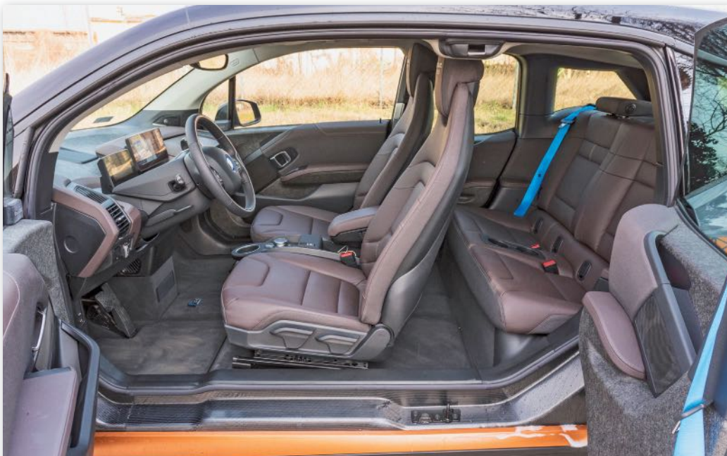
Akár egy tanulmányautó – nem is változott sokat a 2011-es i3 Concept-hez képest. A küszöbnél szándékosan maradt látható a vázhoz használt karbon (CFRP), beszállni hátra is könnyű
