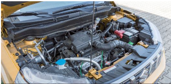
Nem a Toyotáé a hajtáslánc, a Suzuki saját, 1,5-ös benzinmotor köré épített hibrid rendszert pakolt a Vitarába
