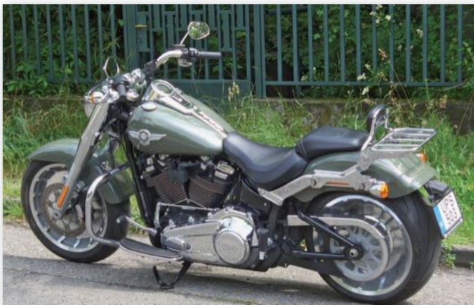
A tengelytáv hosszú, a bukócső gyári extrafelszerelés, a hátsó lábtartókat – mint az összes új Softail-en – kicsit túl előre szerelték; kinyitva a parkolási manővereknél útban lehetnek a vezető lábának
