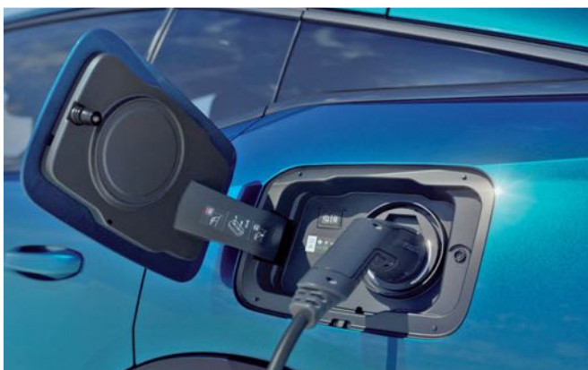
Szerény teljesítményű a 3,7 kW-os töltő, a lassúsága sokakat eltántoríthat a rendszeres villanyüzem használatától
