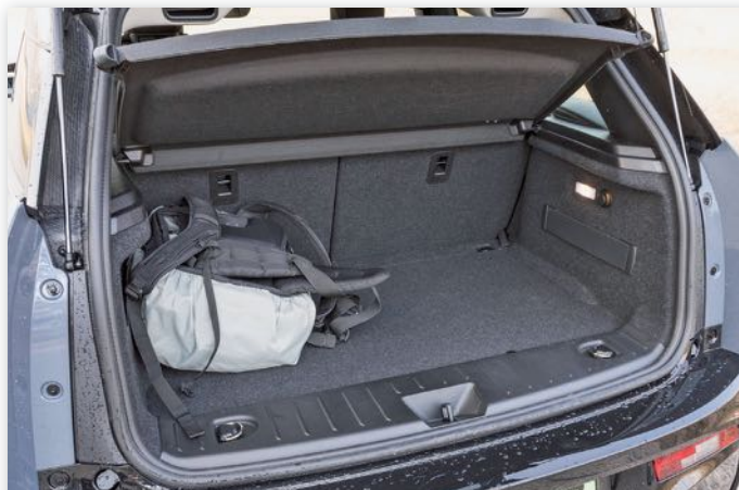
Közepes méretű fotós hátizsák van a csomagtartóban. Álpadló nincs, mert a hátsó tengely köré építették a gépészetet, kellett a hely
