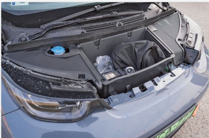
Nyitható a „gépháztető”, bár a villanymotor hátul van. Ide előre a kötelező tartozékokat és a töltőkábelt tehetjük
