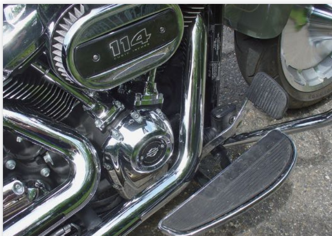
Kényelmes a széles lábtartó, a fékpedál hatalmas. A motor „orrkúpja-ban” a gyújtás jeladója és az egyetlen központi vezérműtengely forog
