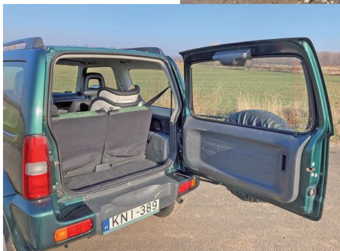
A csomagtartó alapmérete alig több mint 110 l, a szimmetrikus támladöntés alapáras. Zavaró, hogy az ajtó a járda felé nyílik
