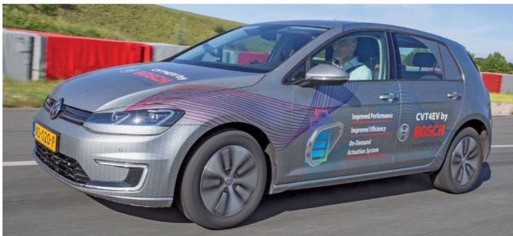
A CVT4EV akár 4000 Nm átvitelére is képes, így elektromos sportkocsikhoz és teherautókhoz is használható
