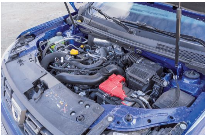
Csendes és takarékos a puha felfüggesztésein terhelésváltásokkor időnként billegő háromhengeres. A motorháztetőt gázrugók tartják nyitva
