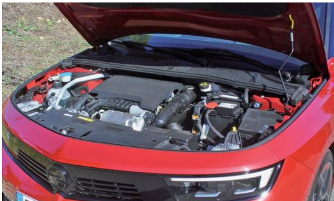
Ez a motortér más Opelekből és PSA modellekből is ismerős. Az 1,2-es benzines bekötési lágyak, emiatt terhelésváltásokkor időnként billeg, és alacsony fordulatszámon a rezgése is jól érezhető
