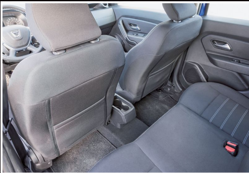
A padlómerevítő nem magas, de széles, az utastér hátul 1,5 centivel szélesebb, mint elől. A támlazsebek a Comfort szinten jelennek meg először
