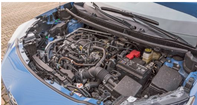
Míg a hibridben szívócső-, itt közvetlen befecskendezéses a változó vezérlésű, turbó nélküli háromhengeres
