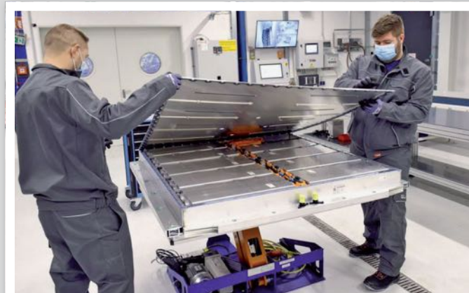
Villanyautó akkumulátorának bontása egy egyelőre kísérleti újrahasznosító üzemben: munka és költségigényes folyamat
