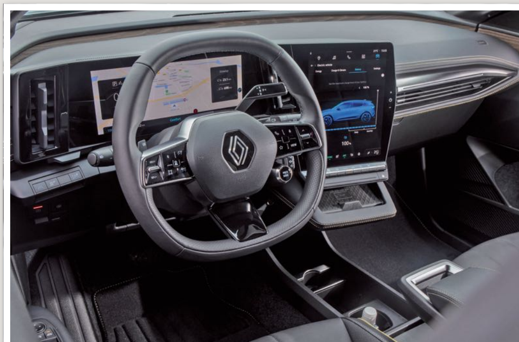
L-alakú műszerfal két, nagyfelbontású képernyőből, a vezető előtti panel 12,3 colos
