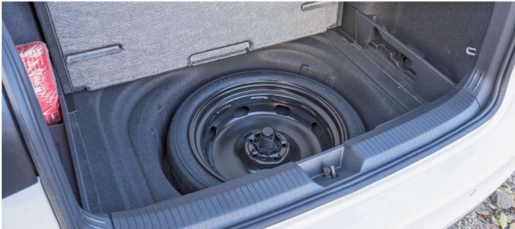
Befelé 1060 mm mély, a kerékdobok között 1010 mm széles a csomagtartó, a rakodóperem magassága 590 mm, ez kedvezően alacsony
