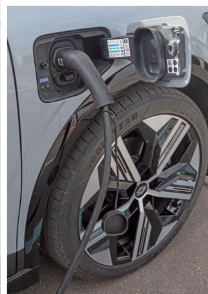
A fedélzeti töltő alapján 7 kW-os, a gyorsöltés legfeljebb 130 kW teljesítményű lehet
