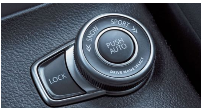
Csak az összkerekhajtású (AllGripp) kivitelek kapnak menetvezérlőt
